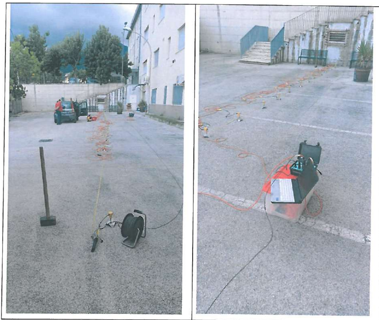
Stendimento per indagine sismica MASW
